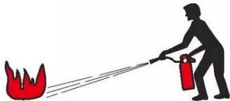
3. SQUEEZE HANDLES TOGETHER AND SWEEP THE EXTINGUISHER STREAM SIDE TO SIDE
